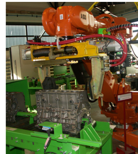
Ilot robotisé de manutention de blocs moteurs pour contrôle par vision.
