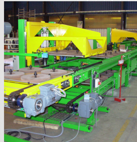
Ligne automatisée de plateaux de noyaux en fonderie.
